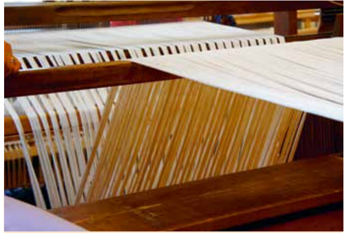
... und jeder Kettfaden muss durch die richtige Öse gehen.
